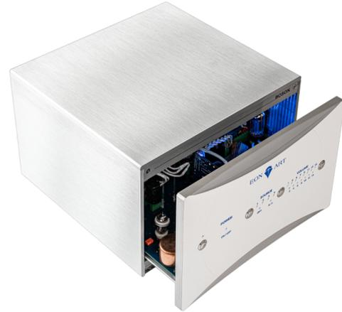
**Vue de 3/4: Un coffret d'aluminium de 7 mm sur une base de pierre semiprécieuse en Labradorite avec une façade massive de 19 mm.**
